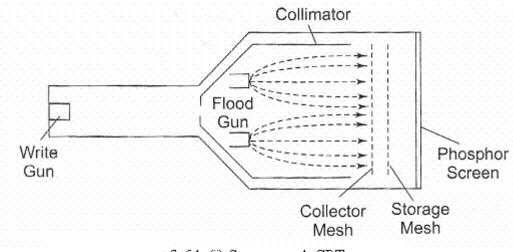
fig6.b.(ii) Storage mesh CRT
