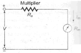
fig 4.a.(i) Basic Voltmeter
